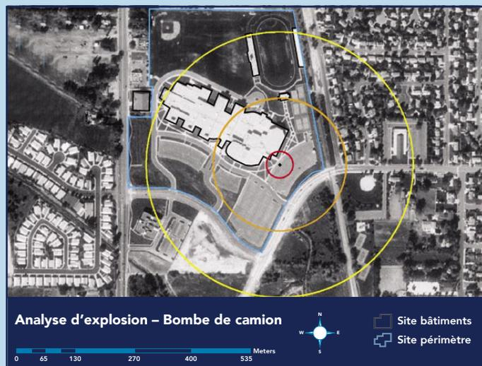
Image 2: Analyse d'explosion d'une école secondaire, avec une bombe de camion détonée dans le parking de l'école.
